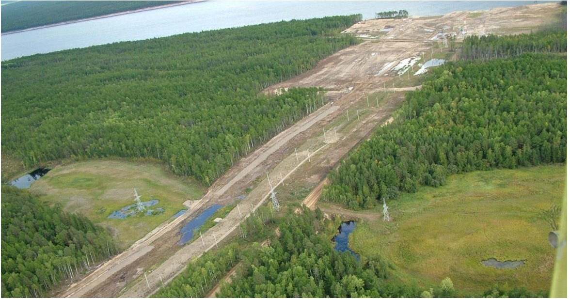
Рисунок 3.3.1 - Термокарст по блюдцевидным понижениям в долинах рек и по участкам тепловых воздействий
