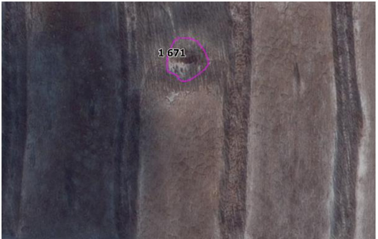
Рисунок 2.3.28 - Эталон дешифрирования термокарста по участкам механических нарушений поверхности почвы (космоснимок)
