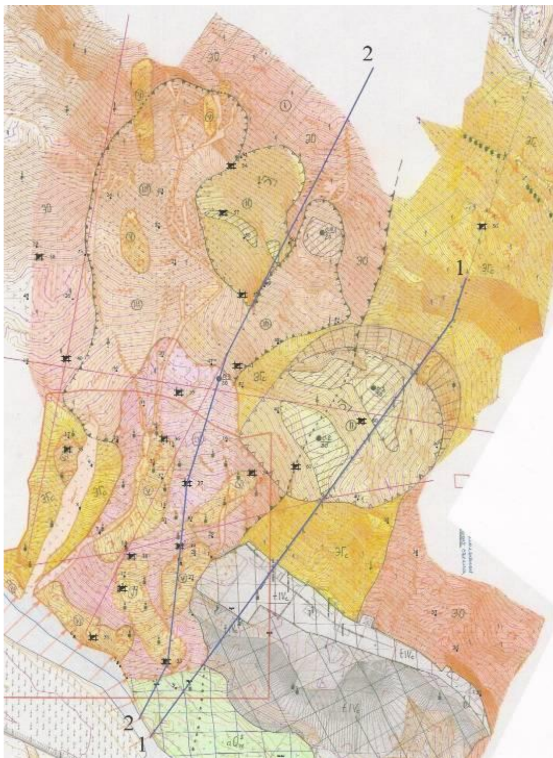
Рисунок 2.10 – Карта-схема активности оползневых процессов в районе южного портала тоннеля № 6 трассы М-27 Дзубга – Сочи, ПК134 – ПК194 (участок обхода Сочи) [238]
