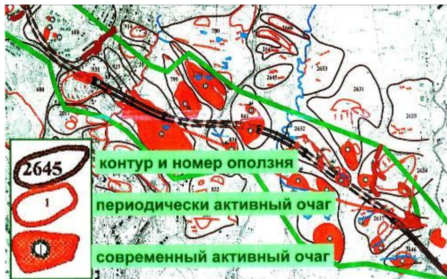
Рисунок 3.2 – Автодорожная ТПТС «Дублер Курортного проспекта», г. Сочи: а) типичная площадка строительства, б) схема оползней на территории строительства II очереди [231]
