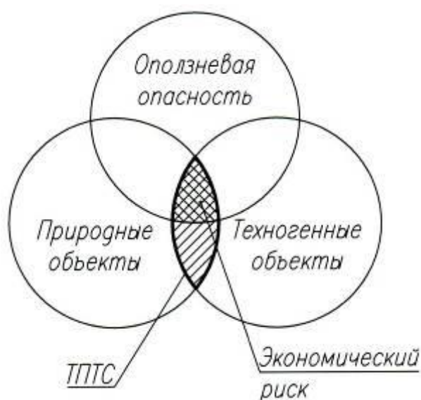
Рисунок 3.1 – Структурная схема ТПТС на оползнеопасных участках
