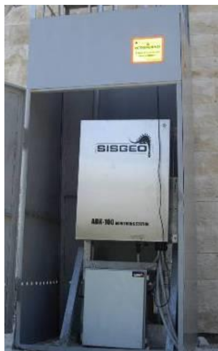
Рисунок 5.10 – Блок сбора информации с геотехнического оборудования в процессе мониторинга
