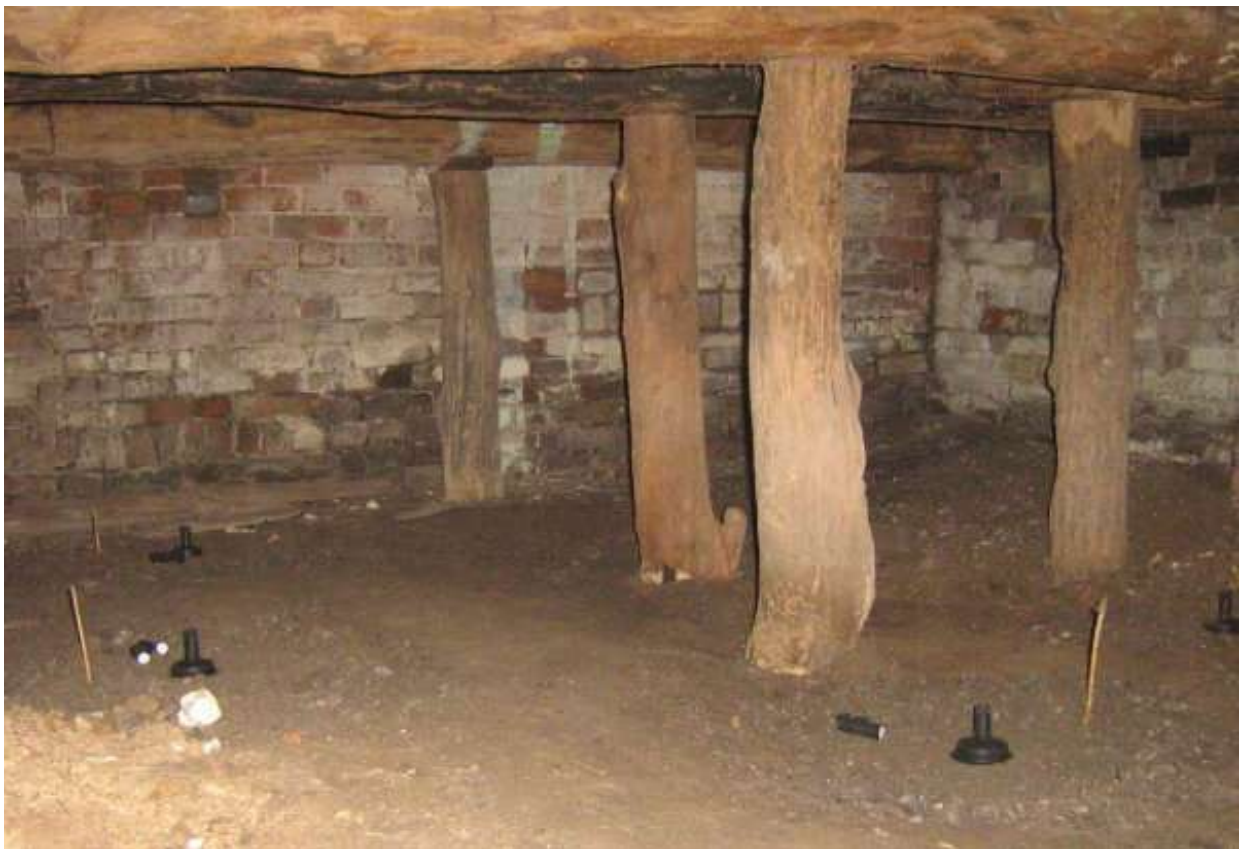
Рисунок 19. Расположение накопительных камер в подвале дома.
