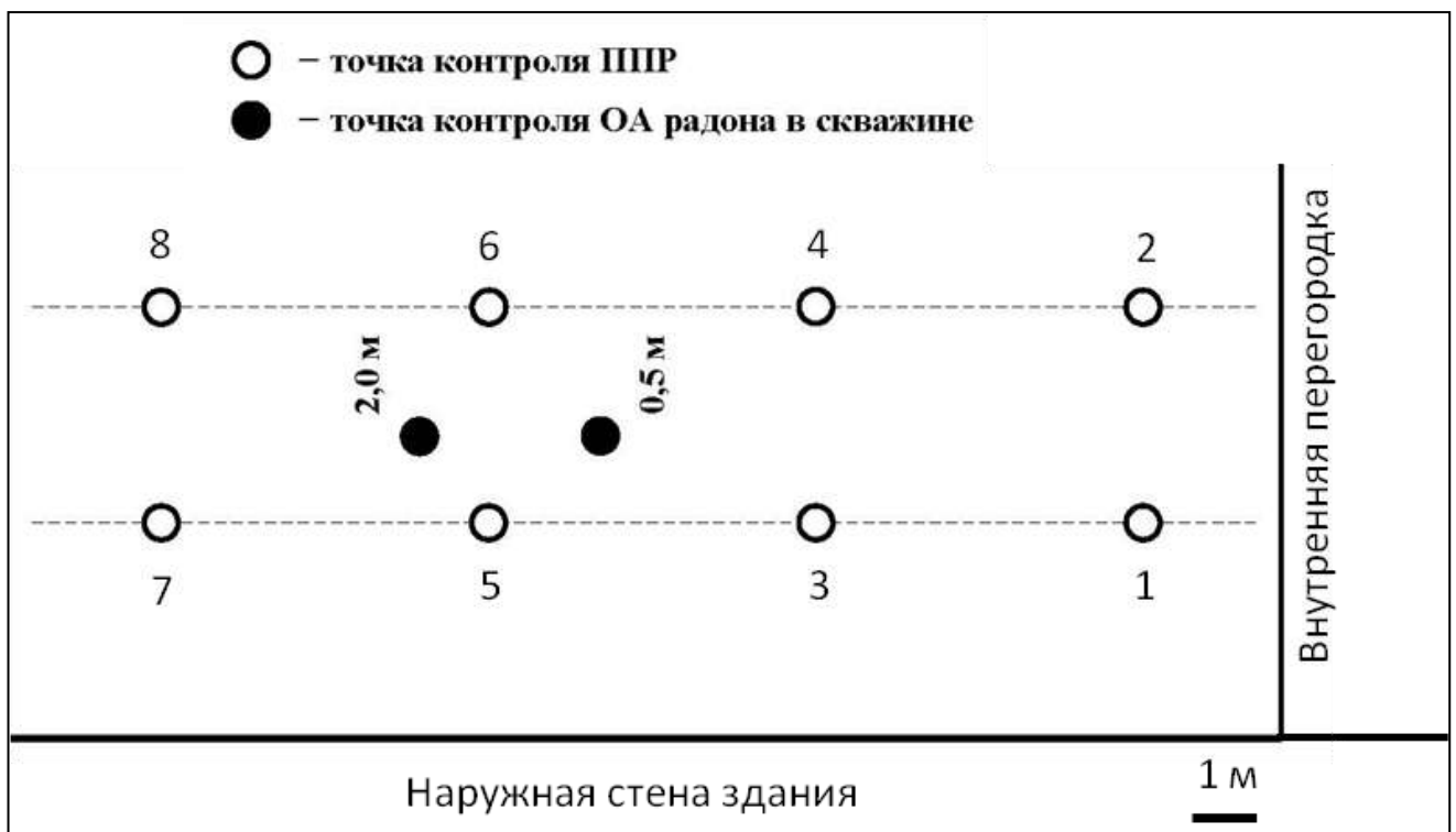
Рисунок 24. Схема расположения точек мониторинга ОА радона в подпочвенном воздухе и плотности потока радона с поверхности грунта в подвале здания ИГФ УрО РАН.
