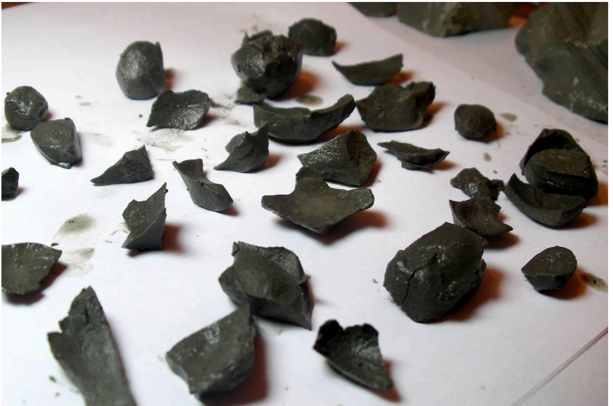
Рис. 26. Отдельности, на которые распался образец по системе внутренних скрытых трещин.
