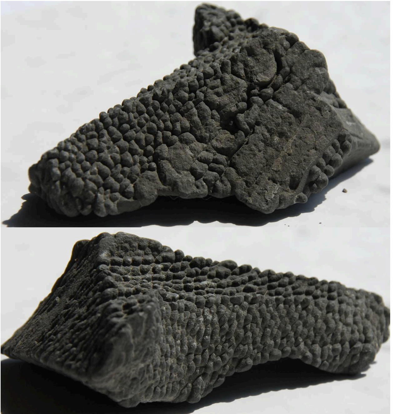
Рис. 42. Образец аргиллитоподобной глины после отмывания его поверхности под проточной водой.
