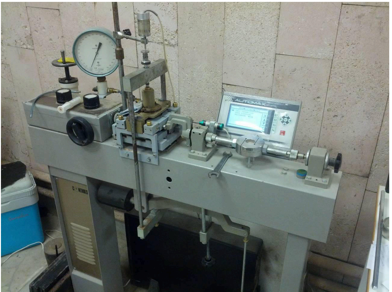
Рис. 21. Общий вид прибора “Controls Shear tester T207 Digital” для испытаний грунтов на сдвиг.
