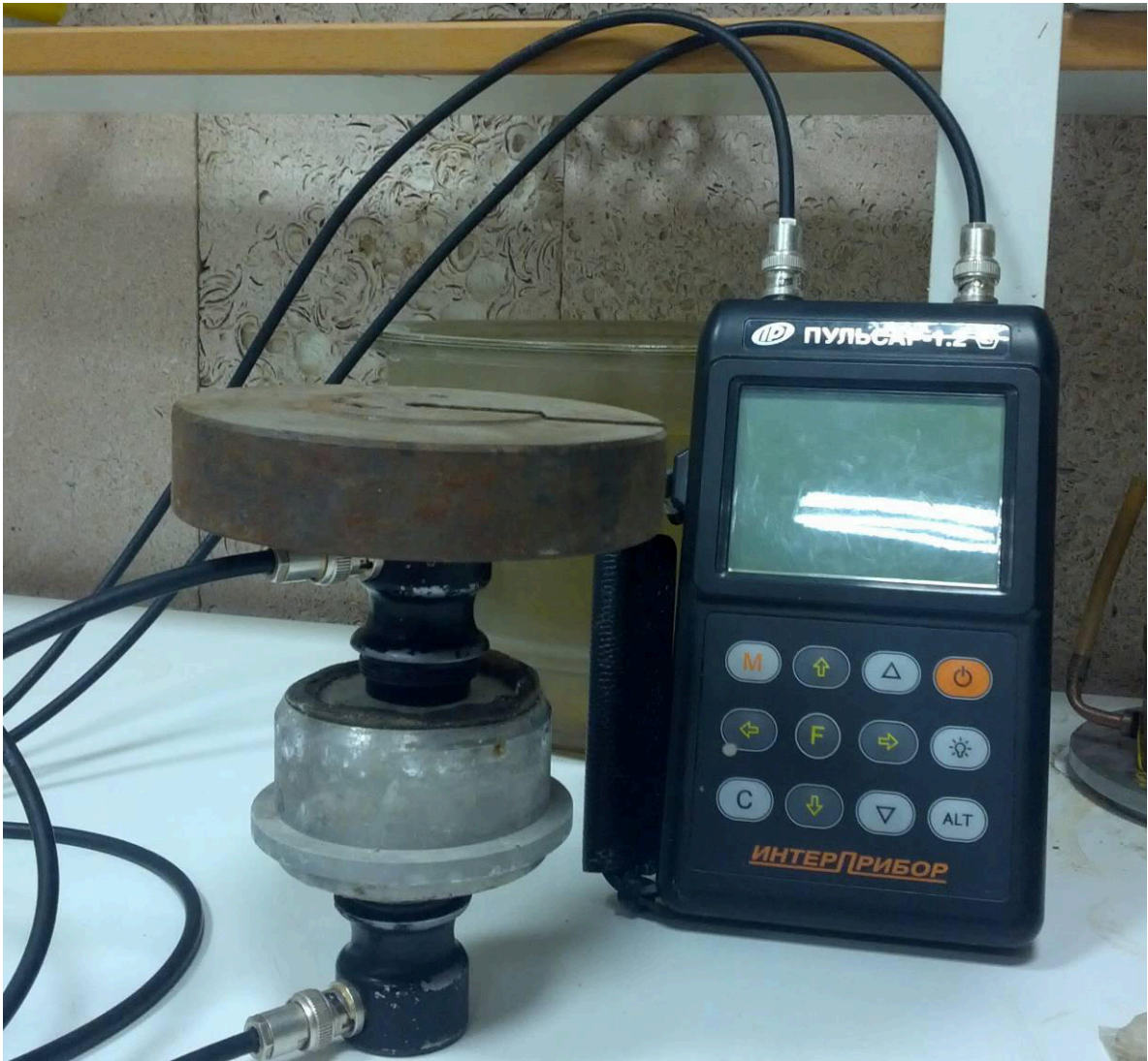
Рис. 24. Прибор - генератор ультразвука "Пульсар 1.2"
