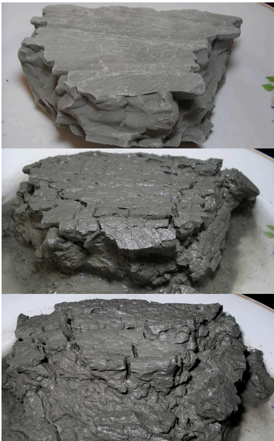
Рис. 20. Свободное размокание аргиллитоподобной глины в течение 8 часов
