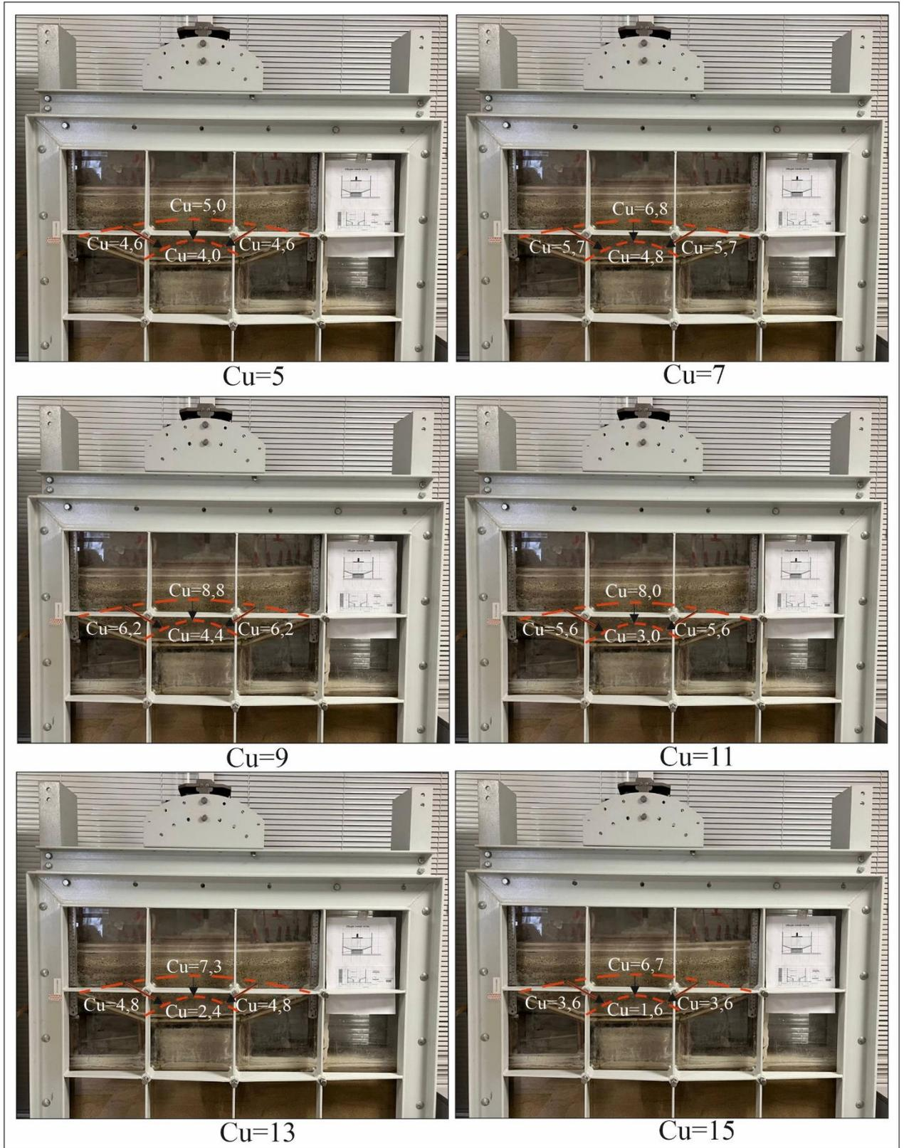
Рисунок 5.18. Схема условного зонирования толщи карбонатной муки в зависимости от изменения степени неоднородности гранулометрического состава  $C_u$
