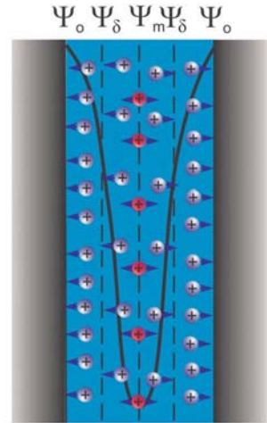
Рис. 5.13. Изменение потенциала в зазоре между двумя плоскими частицами при высушивании ( a ) и появлении сил ионно-электростатического притяжения при уменьшении толщины гидратной прослойки ( б ).
