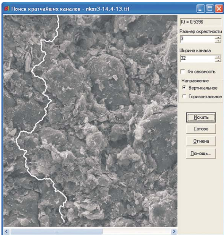
Рис. 7.19. Оценка коэффициента извилистости поровых каналов в глинистой породе по РЭМ-изображению.
