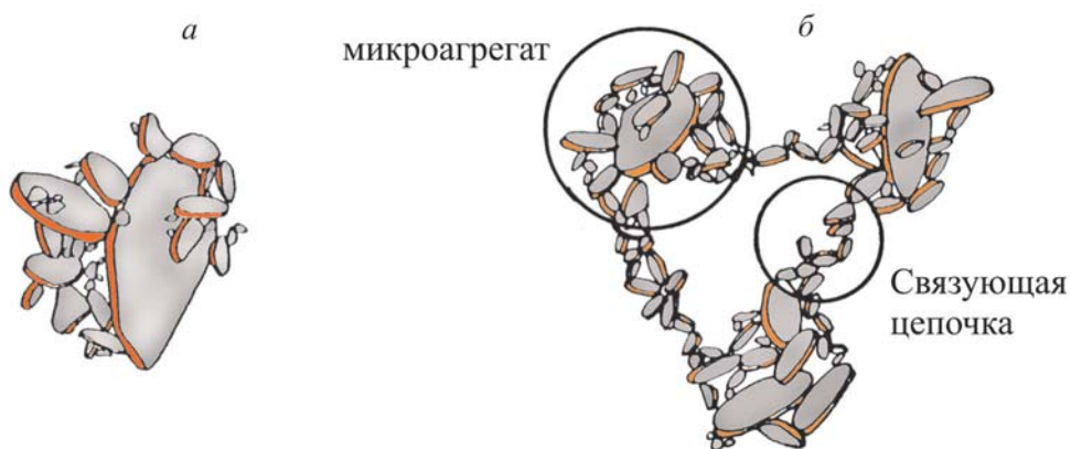
Рис. 9.9. Отдельный микроагрегат ( а ) и связи микроагрегатов внутри структуры чувствительных глин ( б ) (Pusch, 1970).
