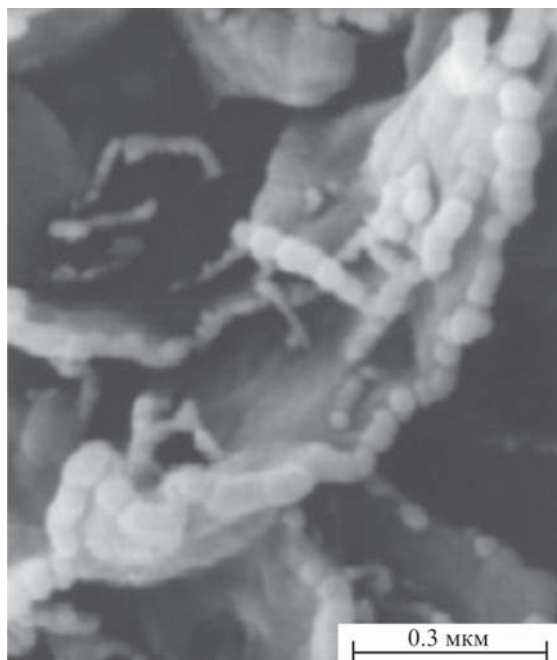
Рис. 7.38. Глобулярные агрегаты гумусового вещества на торцах глинистых микроагрегатов.
