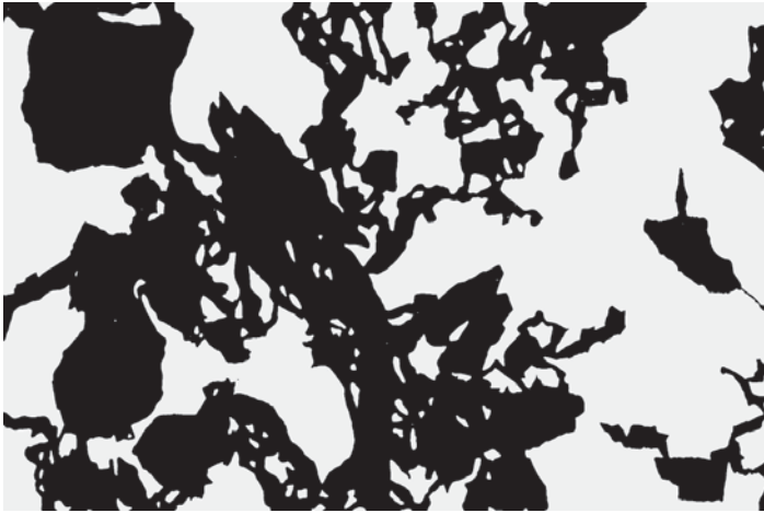
Рис. 9.10. Электронная микрофотография ультратонкого среза чувствительной глины (Pusch, 1970).
