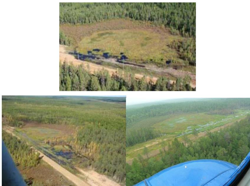
Рисунок 1.32 Различная степень поверхностного обводнения одного и того же участка нефтепровода в 2010, 2011 и 2012 г.г. соответственно.
