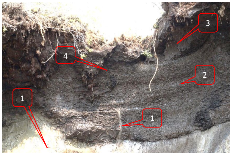
Рисунок 5. Строение разреза частично оттаявших полигонально-жильных льдов первой надпойменной террасы р.Чары после затухания термокарстовых процессов: 1 – повторно-жильный лёд; 2 – многолетнемёрзлые таберированные оторфованные супеси с горизонтально-слоистой криогенной текстурой; 3 – оторфованные супеси сезонноталого слоя; 4 – морозобойная трещина (фото Д.М.Шестернёва).
