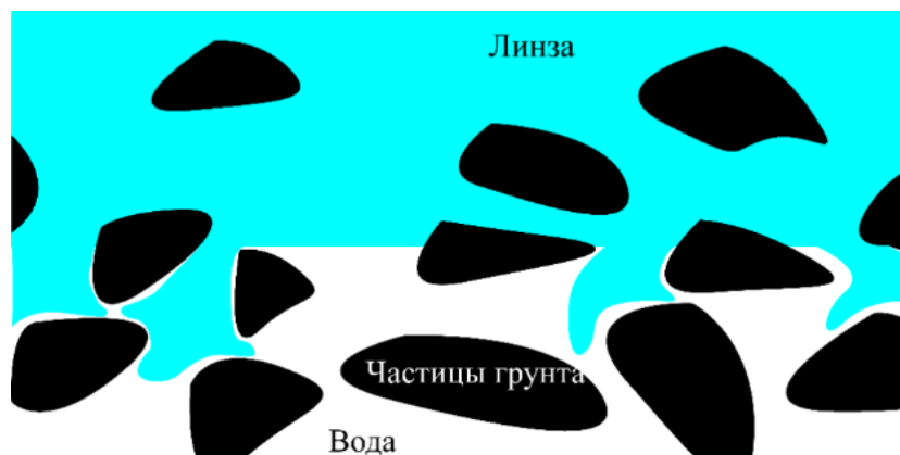
Рис. 3.1.2. Схема каймы промерзания (модель жёсткого льда)(Miller, 1972)
