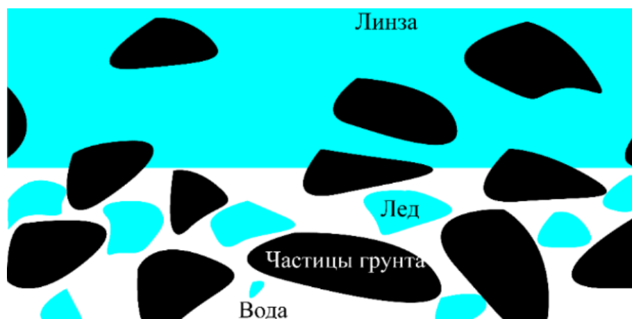
Рис. 3.1.3. Схема «замерзающей каймы» (модель сегрегационного льда)(Gilpin, 1980)
