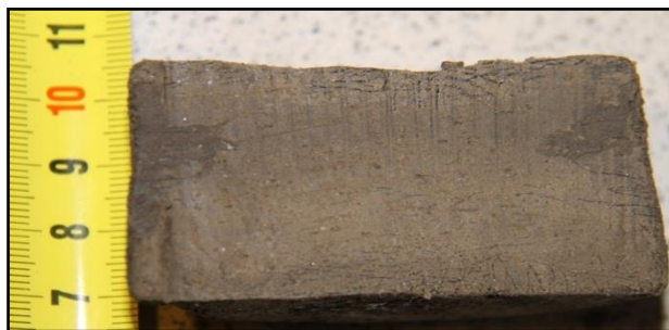
Рисунок 2.2. Образец суглинка с массивной криогенной текстурой.
