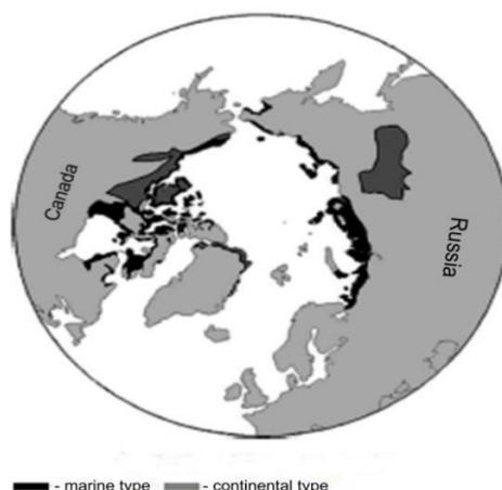
Рисунок 1.1. Схема распространение засоленных многолетнемерзлых грунтов в Северном полушарии в зависимости от морского (черный) и континентального (серый) типов засоления (Брушков, 1998).
