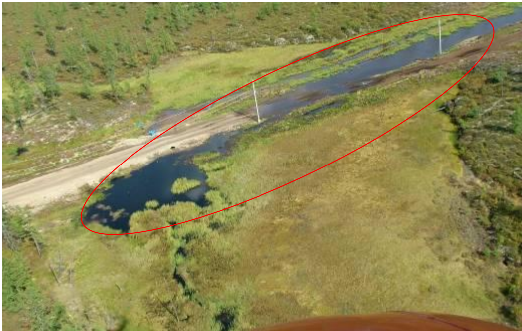
Рисунок 2.3.33 - Эталон дешифрирования термокарста по участкам нарушения поверхностного стока (фото)
