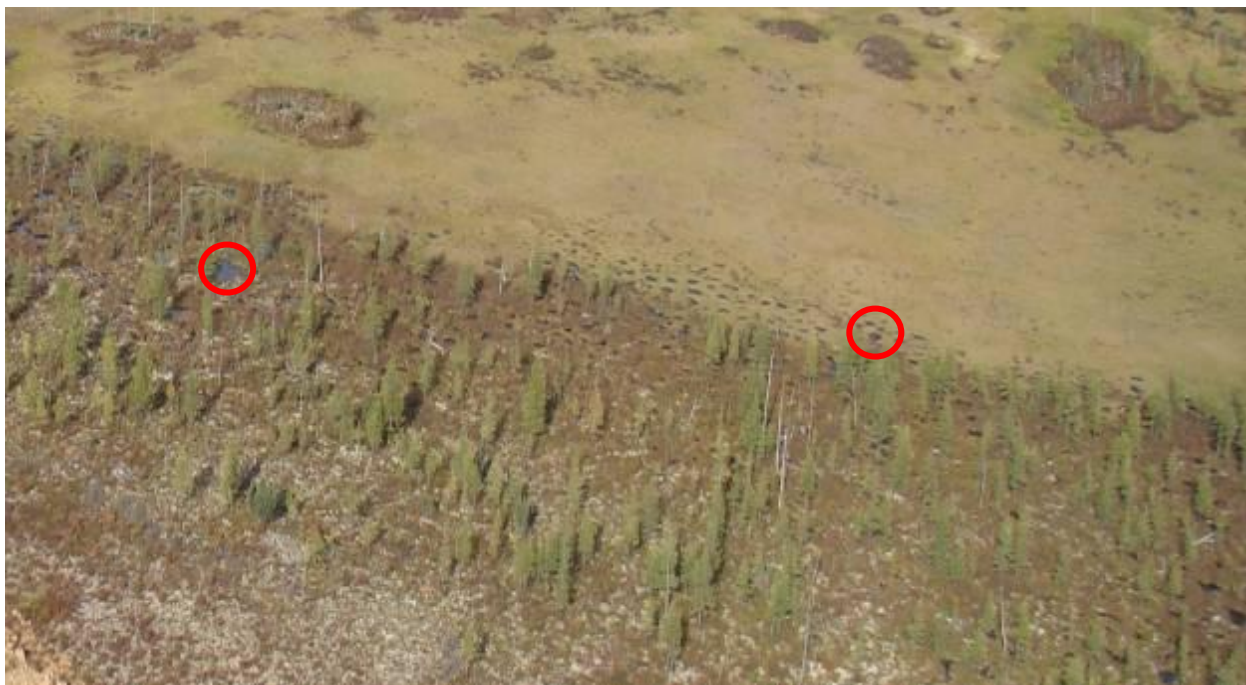
Рисунок 2.3.23 – Эталон дешифрирования мелкоячеистого термокарста (фотоснимок)
