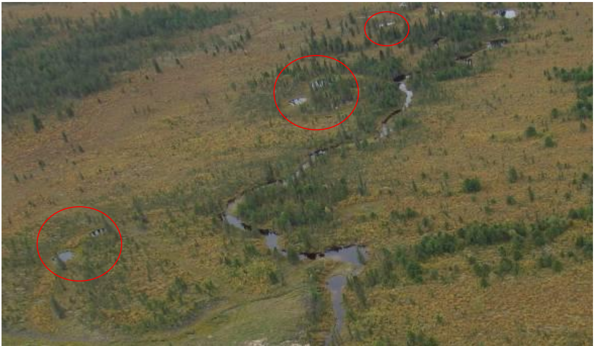
Рисунок 2.3.10 - Эталон дешифрирования термокарста по пойменным и террасным старицам рек
