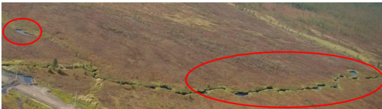
Рисунок 2.3.2 - Эталон дешифрирования для расширений по руслам рек и днищам ложбин временных водотоков (четковидный сток) (фотоснимок)
