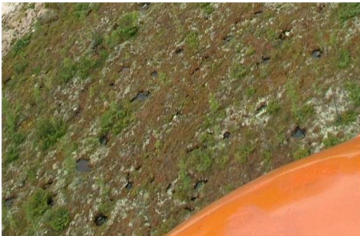
Рисунок 2.3.24 - Эталон дешифрирования мелкочечистого термокарста (фотоснимок)
