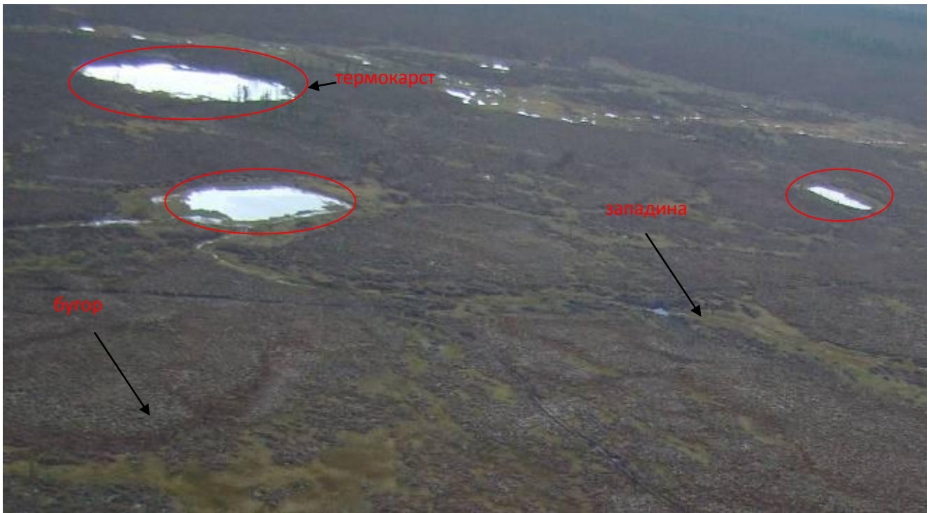
Рисунок 2.3.18 - Эталон дешифрирования термокарста по бугристым торфяникам (фотоснимок)
