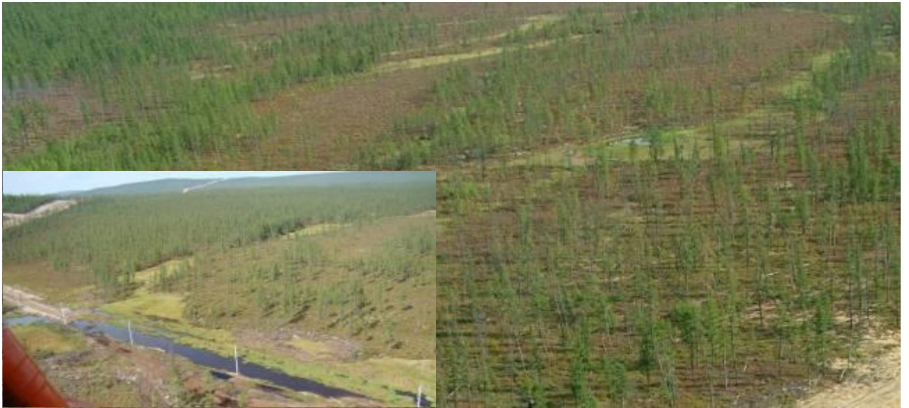
Рисунок 3.3.3 - Термокарст по участкам нарушения поверхностного стока и по ложбинам подповерхностного стока
