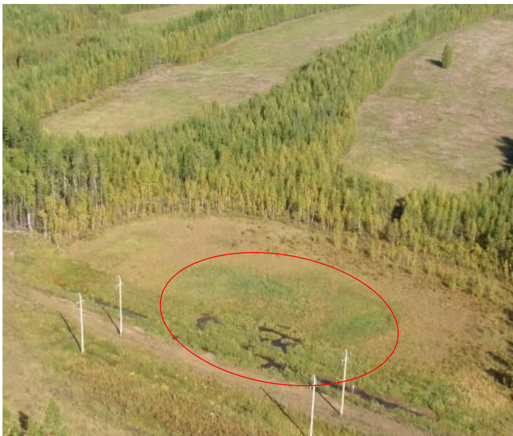
Рисунок 2.3.27 - Эталон дешифрирования термокарста по участкам механических нарушений поверхности почвы (фотоснимок)
