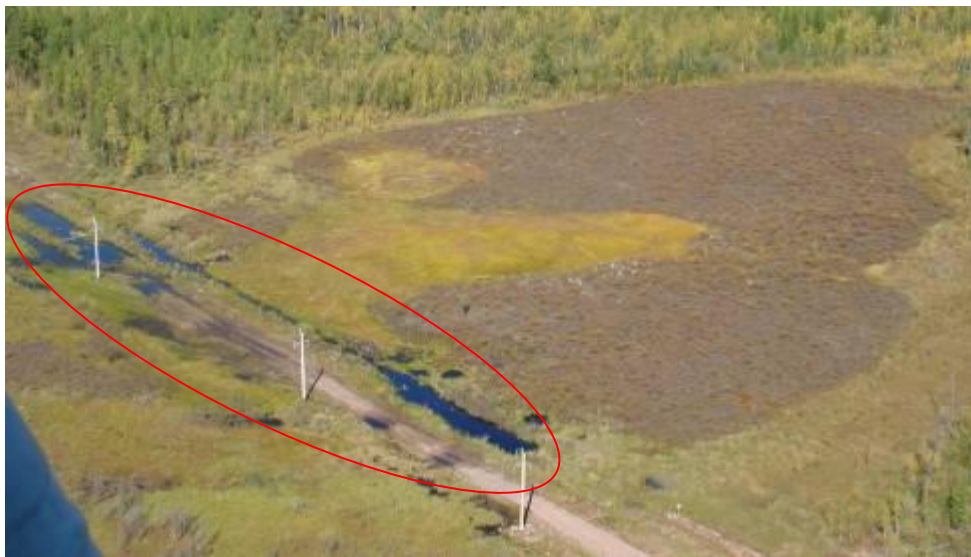
Рисунок 2.3.30 - Эталон дешифрирования термокарста по участкам тепловых воздействий на фотоснимке
